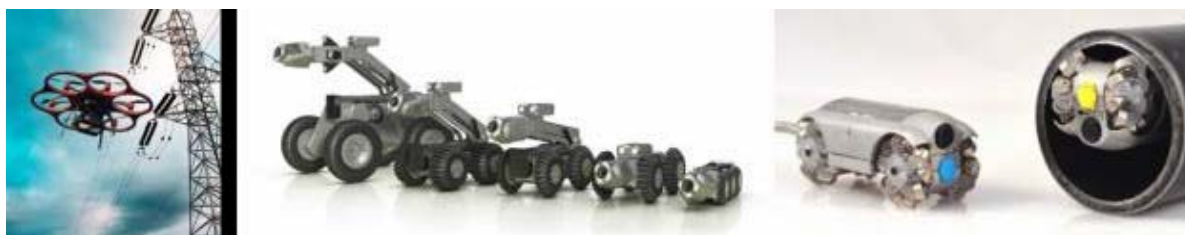
图 4 基础设施检测机器人：ULC 的无人空中检测机，以及 EnviroSight 和 Honeybee Robotics 的管道检测爬行器
