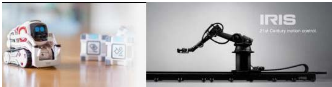
图 6: 左: Anki Robotics 的 Cozmo 机器人, 配备了传感器、机载计算和用于用户编程的计算机接口, 同时还赋予了机器人“个性”。右: Bot & Dolly 公司(最近被谷歌收购)的虹膜电影运动控制系统
